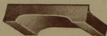
26.—Pieza de hierro fundido, que tapa un extremo de las hélices suplementarias.
