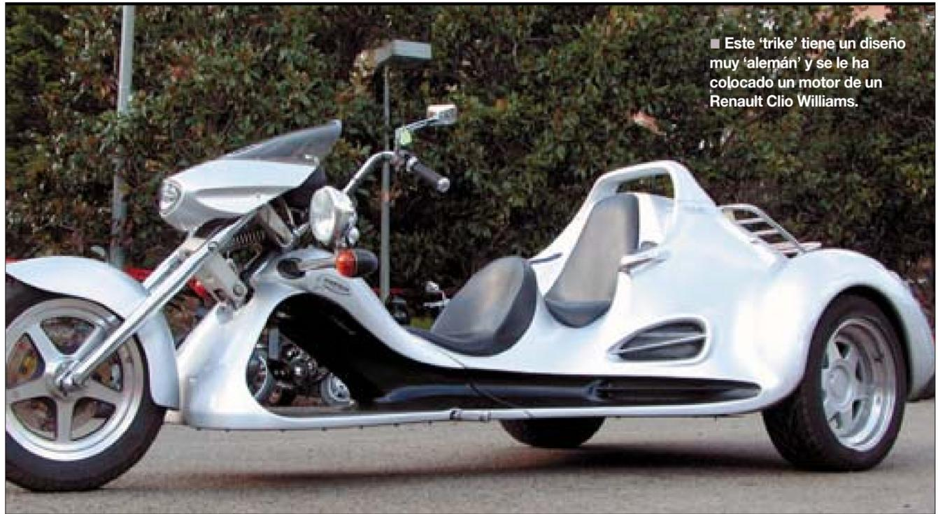
■ Este 'trike' tiene un diseño muy 'alemán' y se le ha colocado un motor de un Renault Clio Williams.
